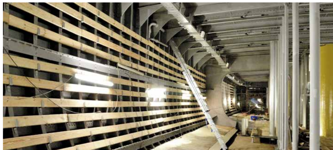
Der 85 Meter lange durchgängige Salpeter-Frachtraum – mit hölzernen „Schweißblättern“ an den Außenwänden für die Luftzufuhr.
