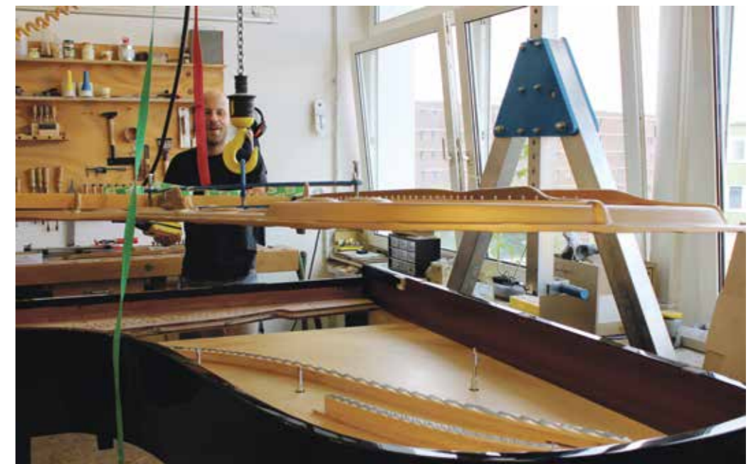
Klavierbauer Stefan Bammann senkt eine Gussplatte in den aufgearbeiteten Steinway-Flügel ab: „Wir erhalten den Klangkörper und verbinden ihn mit moderner Technik.“ © DAGMAR LEISCHOW
