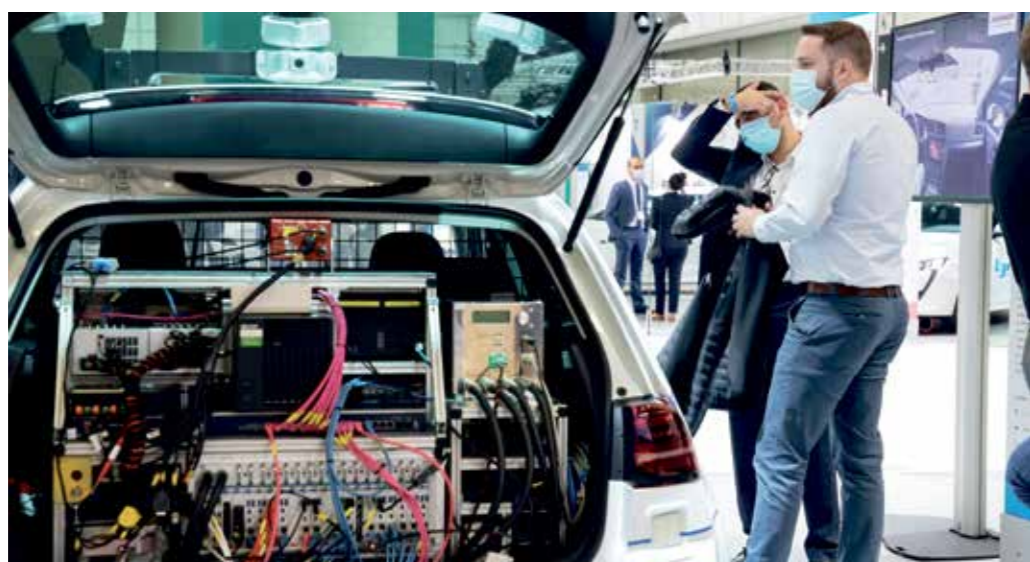
Der Kofferraum eines autonom fahrenden VW-Golf, vorgestellt auf der ITS, sieht noch aus wie ein Computerschrank eines mittelständischen Industrieunternehmens.
