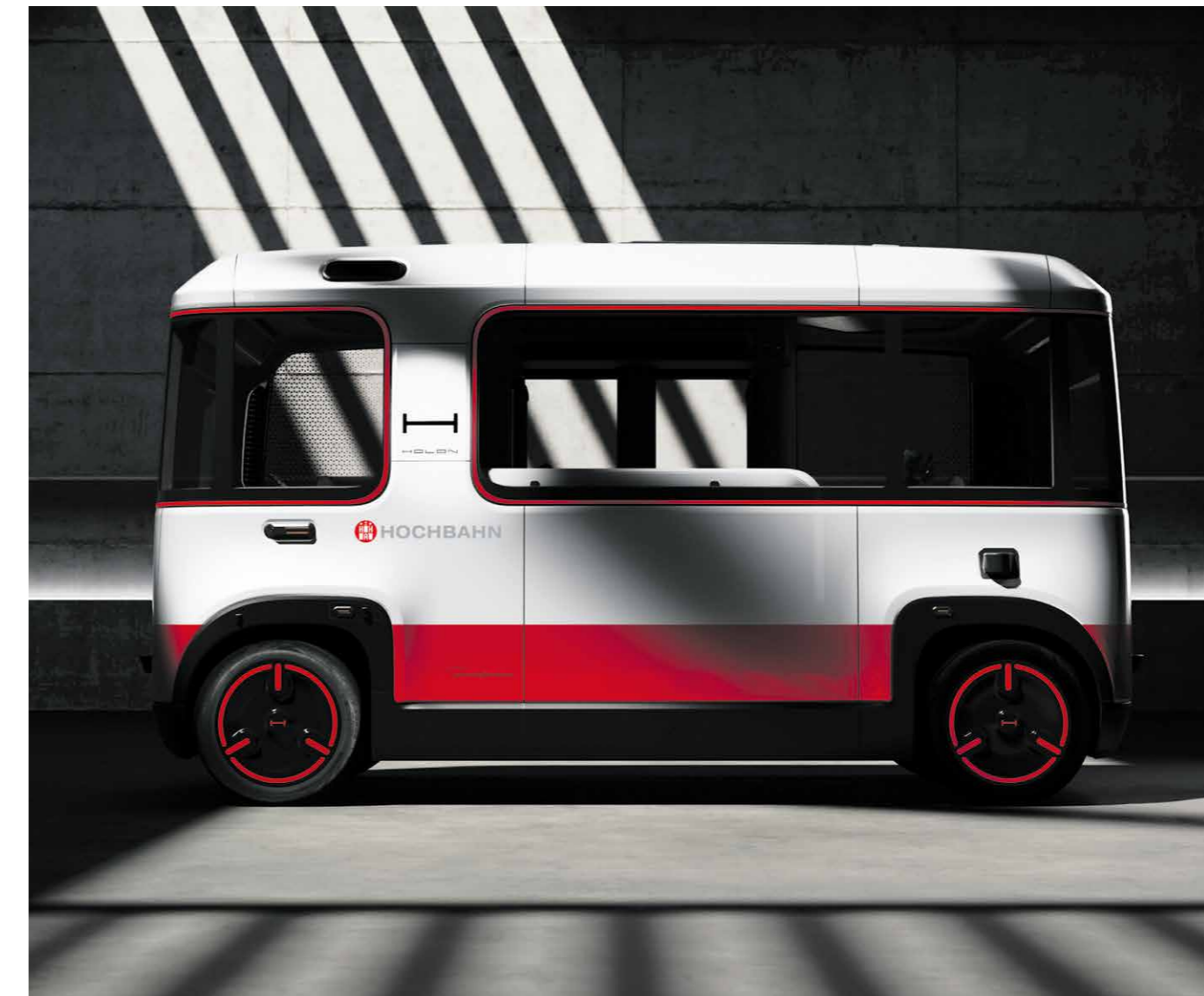
Der vollautomatische, vollelektrische und inklusive ÖPNV-Kleinbus „Mover“ von Holon bietet zehn Sitz- und fünf Stehplätze und schafft 60 km/h. Pilotprojektpartner für Hamburg ist die Hochbahn AG. Ab 2024 sollen die Mover in der Innenstadt starten. © HOLON
