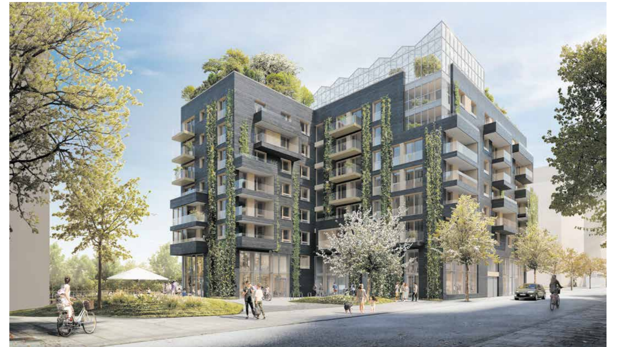
Autonome Nachhaltigkeit im „we-house“ von Gerd Hansen: „Das Konzept dieser Kreislaufwirtschaft wird bislang nur im ‚we-house‘ praktiziert. Das Dachgewächshaus wird mit der Abwärme des Gebäudes beheizt, die Pflanzen werden durch Regenwasser bewässert, und Pestizide werden weder eingesetzt noch benötigt. Transportwege und -kosten entfallen, denn die Lebensmittel vom Dachgarten kommen frisch geerntet direkt auf den Teller. Das reduziert den ökologischen Fußabdruck der Lebensmittelversorgung drastisch.“ © WE-HOUSE | ARCHY NOVA PROJEKTENTWICKLUNG
