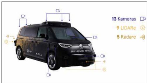
Der ID. Buzz AD ist mit 13 Kameras und fünf Radaren sowie neun LiDAR-Sensor-Systemen für Abstands- und Geschwindigkeitsmessungen ausgestattet. © MOIA
